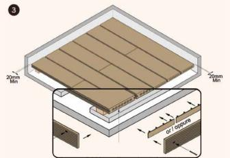
SE È UTILIZZATO IL TAPPO DI CHIUSURA È NECESSARIO FARE UN FORO AL DI SOTTO DEL PROFILO PER FARE SCOLARE L'ACQUAIIF YOU USE FINISHING PROFILES, MAKE A HOLE IN THE BOTTOM OF THE PROFI-LE FOR WATER DISPOSAL.
